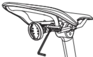
1. Inserte la ranura del soporte del sillín en el arco del sillín y fíjelo con una llave Allen.
