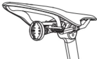
3. Asegúrese de que el botón del dispositivo esté orientado hacia arriba y haga coincidir la hebilla trasera con la ranura del asiento de fijación. Gire en sentido horario a la posición de sujeción. En este momento, la interfaz USB del producto debe estar ubicada en la parte inferior, que es la dirección de uso estándar del producto.
