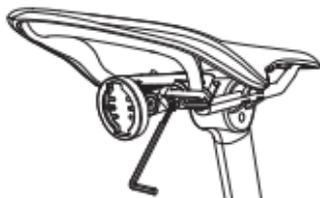
1. Stecken Sie die Nut der Sattelhalterung in den Sattelbügel und befestigen Sie sie mit einem Innensechskant-Schlüssel.
