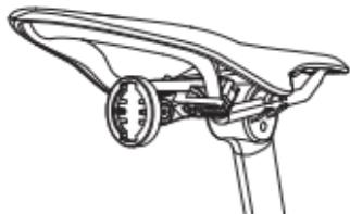
3. Achten Sie darauf, dass die Gerätetaste nach oben zeigt und die Rückenschnalle in den Steckplatz des Befestigungssitzes passt. Drehen Sie im Uhrzeigersinn in die Befestigungsposition. Zu diesem Zeitpunkt sollte sich die USB-Schnittstelle des Produkts an der Unterseite befinden, was der standardmäßigen Verwendungsrichtung des Produkts entspricht.
