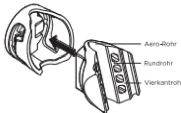
1. Wählen Sie die geeignete Position für das Gummipolster entsprechend der Form Ihrer Sattelstütze und platzieren Sie das Gummipolster auf der Rückseite des Befestigungswinkels.
