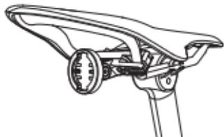
3. Assicurarsi che il pulsante del dispositivo sia rivolto verso l'alto e corrisponda alla fibbia posteriore con la fessura della sede di fissaggio. Ruotare in senso orario fino alla posizione di fissaggio. A questo punto, l'interfaccia USB del prodotto dovrebbe trovarsi nella parte inferiore, che è la direzione di utilizzo standard del prodotto.
