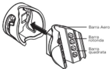
1. Scegliere la posizione adatta per il cuscinetto di gomma in base alla forma del reggisella e posizionare il cuscinetto di gomma sul retro della staffa di fissaggio.
